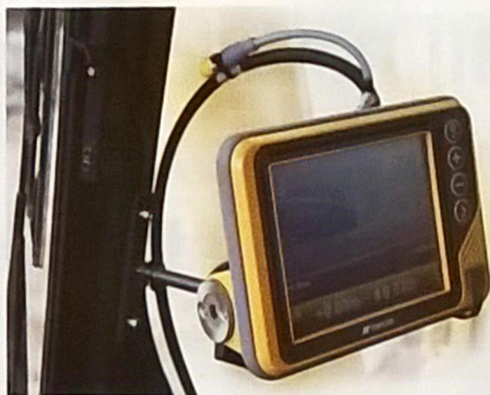
Gerard Bos is trouw gebruik van Topcon machinebesturing en heeft de PC360 SLF uitgerust met de nieuwste X-53i 3D-GPS.
