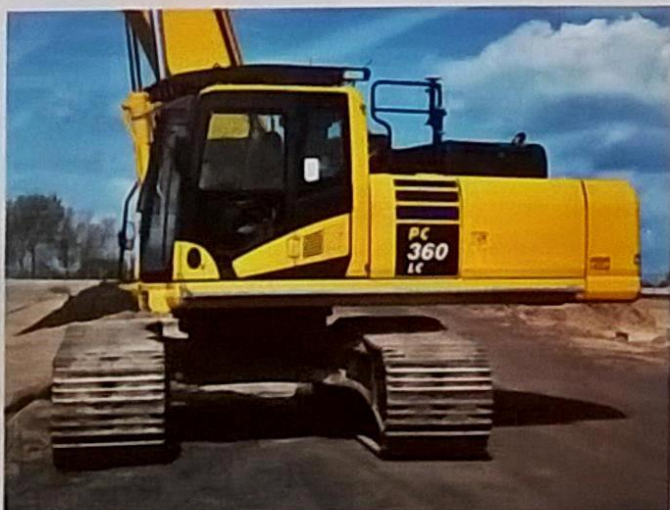
De graafmachine staat op 900 mm brede rupsplaten en heeft een beschermrooster bovenop de cabine.
